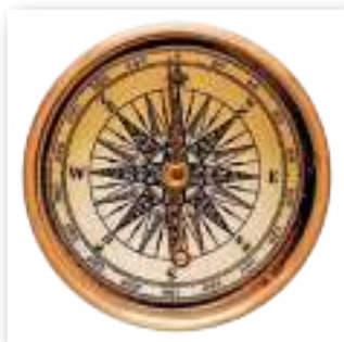
Компас — прылада для вызначэння бакоў свету
