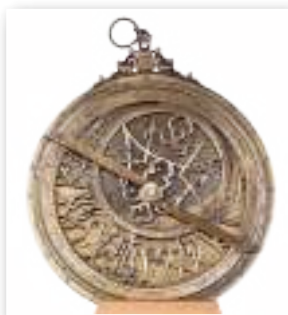
Астралябія — прылада, пры дапамозе якой маракі вымяралі ў адкрытым моры вышыню зораў над гарызонтам
