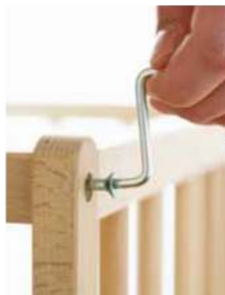
Мал. 138. Устаноўка еўрашруб
