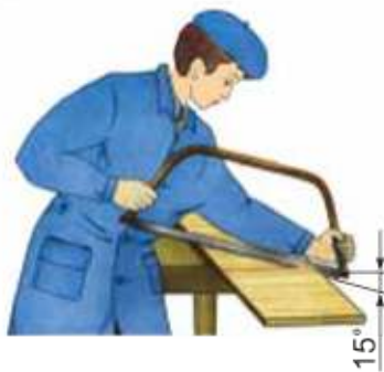
Мал. 45. Вугал нахілу пілы пры пілаванні тоўстых піламатэрыялаў (злева) і тонкіх піламатэрыялаў і фанеры (справа)
