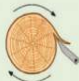
Лущыльная шпона выкарыстоўваецца для вырабу фанеры
