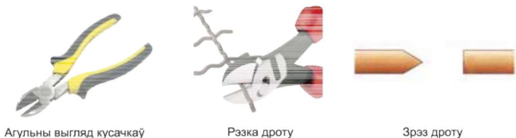
Мал. 121. Рэзка дроту кусачкамі-бакарэзамі
