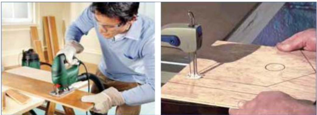
Мал. 65. Работа електричным лобзікам: ручным (злева) і стацыянарным (справа)
