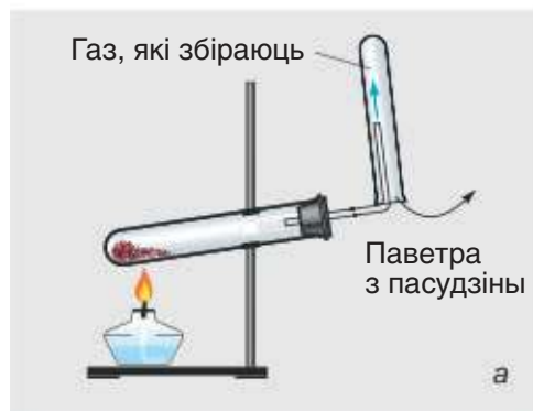
Мал. 55. Схема ўстаноўкі для збірання газаў метадам выцяснення паветра
