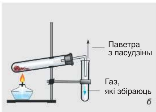
Мал. 55. Схема ўстаноўкі для збірання газаў метадам выцяснення паветра
