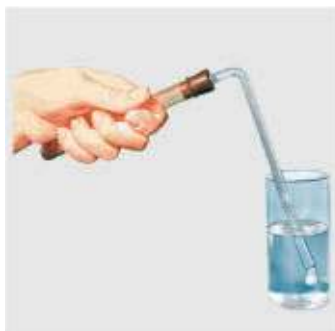
Мал. 57. Праверка прыбора на герметычнасць
