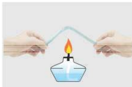
Мал. 41. Згінанне шкляннай трубки пры нагрэванні
