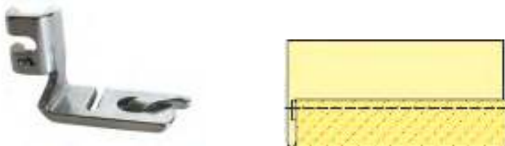
Рис. 66. Лапка-рубильник (а), шов вподгибку с закрытым срезом (б)
