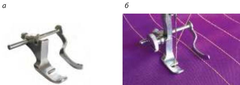
Рис. 68. Лапка с направляющей линейкой (а), выполнение стёжки (б)
