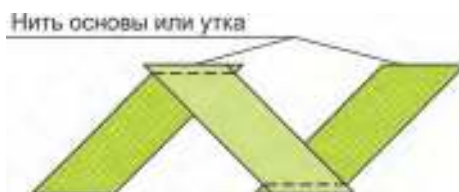
Рис. 81. Соединение частей оборки
