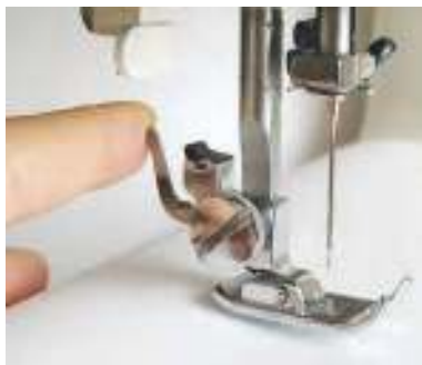
Рис. 73. Последовательность установки лапки
