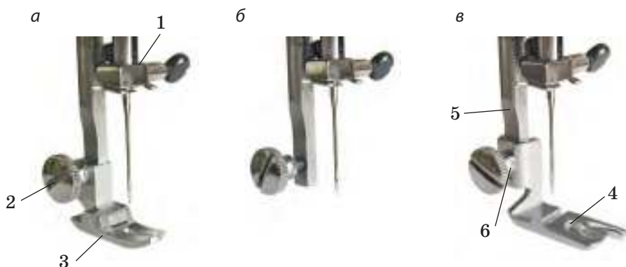
Рис. 72. Последовательность установки лапки
