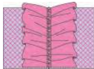
Рис. 86. Соединение рюша с основной деталью
