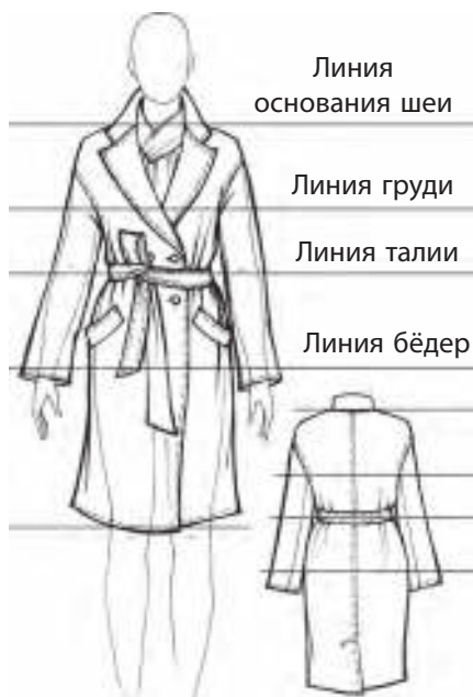
Рис. 39. Технический рисунок модели одежды
