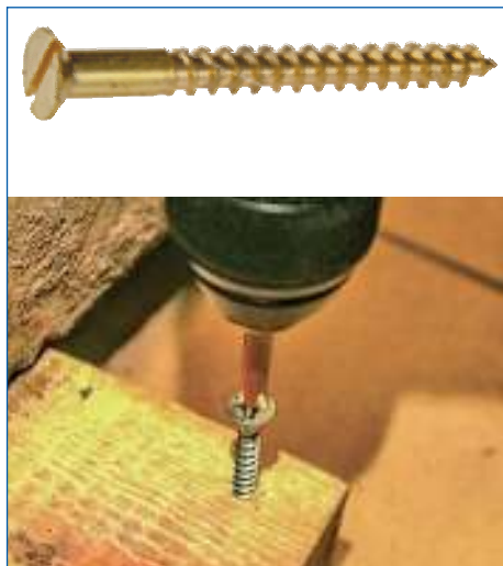
Рис. 66. Шуруп (вверху) и сборка на шурупах (внизу)
