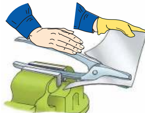
Рис. 110. Резка в слесарных тисках
