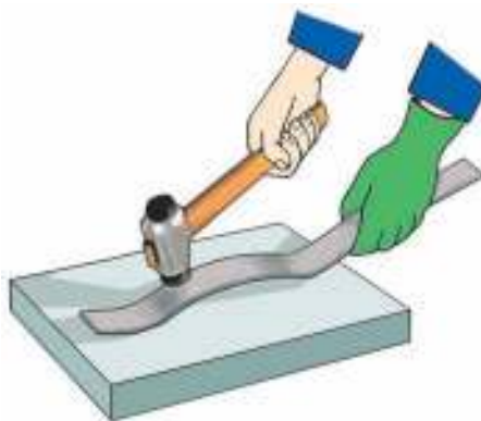
Рис. 98. Правка полосы, изогнутой по пласти
