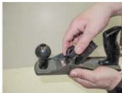
Рис. 39. Наладка рубанка с металлической колодкой
