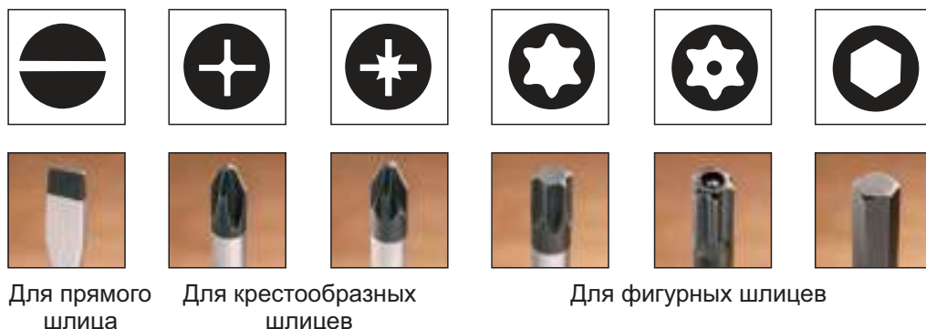
Рис. 71. Разновидности отверток в зависимости от формы шлица
