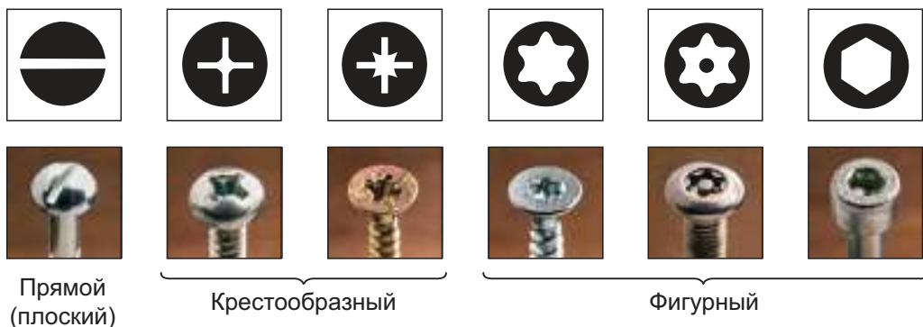
Рис. 67. Виды шлицев шурупов
