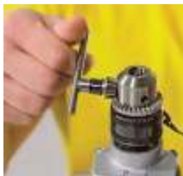
Рис. 54. Виды патронов: ключевой (слева) и быстрозажимной (справа)
