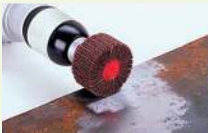
Удаление коррозии с помощью шлифовальных лепестковых кругов
