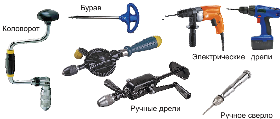
Рис. 51. Инструменты для сверления
