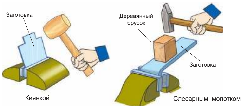
Рис. 113. Гибка заготовок в слесарных тисках
