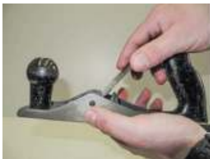
Рис. 39. Наладка рубанка с металлической колодкой
