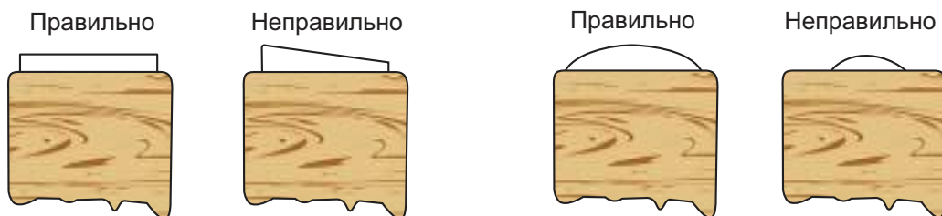
Рис. 37. Проверка выпуска лезвия у рубанка (слева) и шерхебеля (справа)
