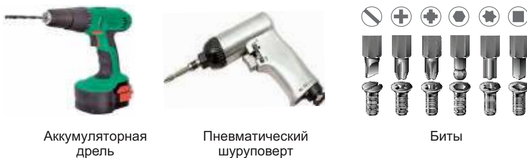
Рис. 72. Электрические инструменты для ввинчивания шурупов
