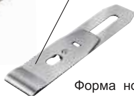
Рис. 32. Рубанок с двойным ножом
