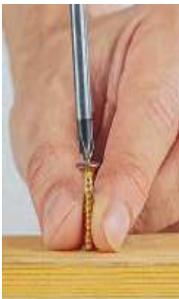
Рис. 76. Прием ввинчивания шурупа
