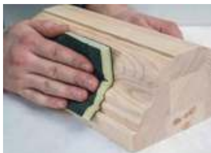
Рис. 63. Шлифовальная губка на поролоновой основе
