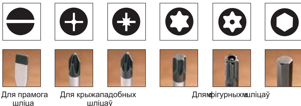
Мал. 71. Разнавіднасці адвёртак у залежнасці ад формы шліца
