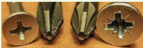
Шрубы: Філіпс (злеваа Позідрайв (справааі адвёрткі для іх
