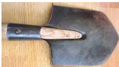
Мал. 126. Зрэзаны на вугал канец дзяржання
