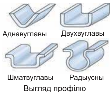
Мал. 116. Гібка на профілегібачных станках
