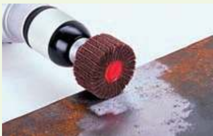
Выдаленне карозіі з дапамогай шліфавальных пялёсткавых кругоў
