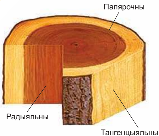
Мал. 1. Галоўныя разрэзы ствала дрэва
