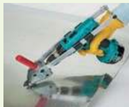
Рэзка металу пры дапамозе насадкі нажніц
