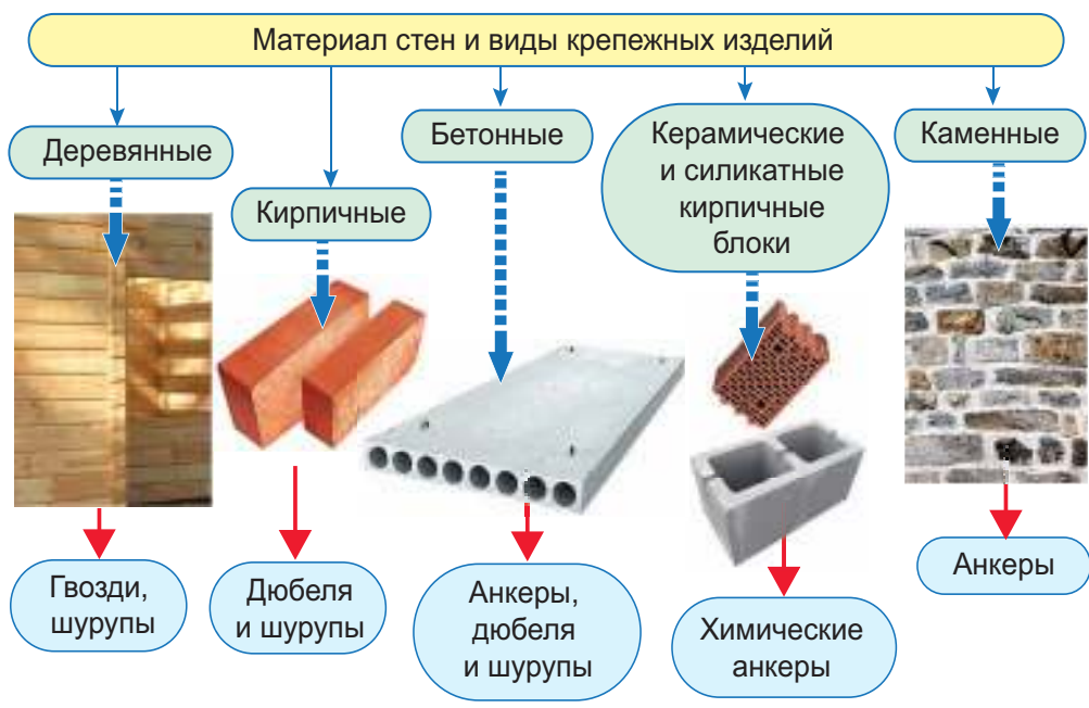
Рис. 133. Виды крепежных изделий в зависимости от материала стены
