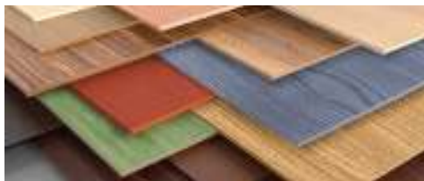
Рис. 16. Древесно-волокнистые плиты средней плотности (МДФ (MDF))
