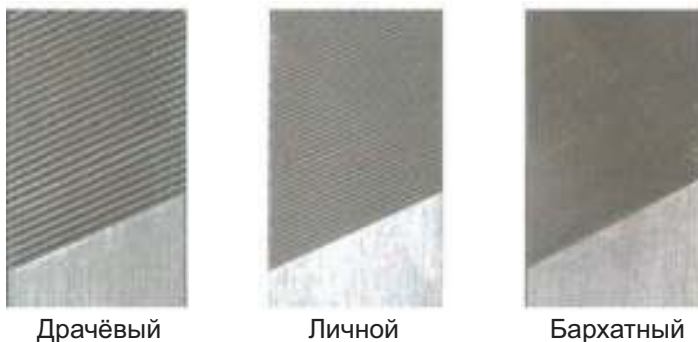
Рис. 105. Виды напильников по количеству насечек
