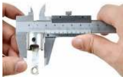
Рис. 83. Приемы хватки штангенциркуля
