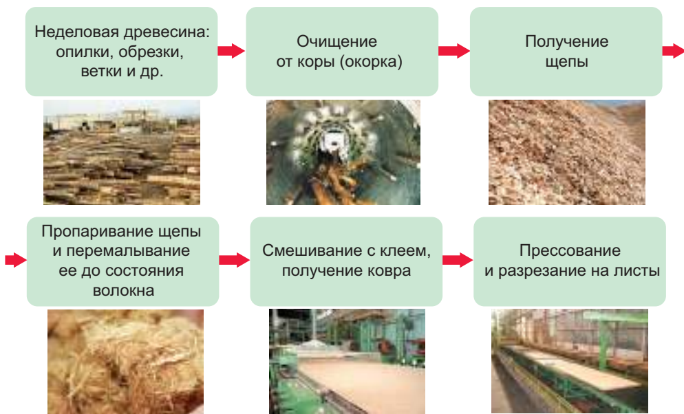
Рис. 15. Процесс производства древесно-волокнистых плит (ДВП)
