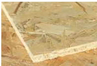
Рис. 13. Плиты с ориентированной стружкой (ОСП (OSB))
