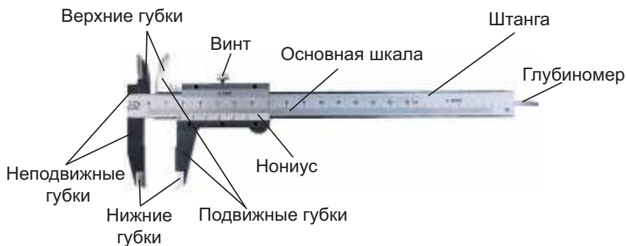
Рис. 79. Устройство штангенциркуля ШЦ—II
