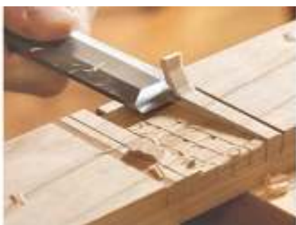
Рис. 48. Срезание древесины стамеской
