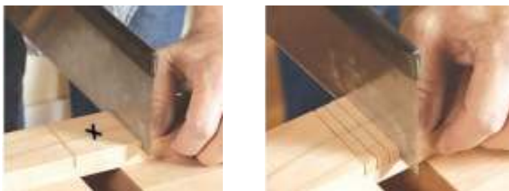
Рис. 45. Запиливание срединного соединения
