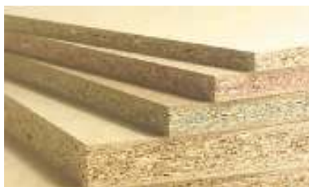
Рис. 7. Древесно-стружечные плиты (ДСтП)
