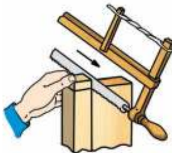
Рис. 26. Выполнение запила лучковой пилой
