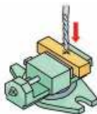
Сверление в машинных тисках
