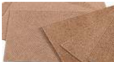
Рис. 14. Древесно-волокнистые плиты (ДВП)
