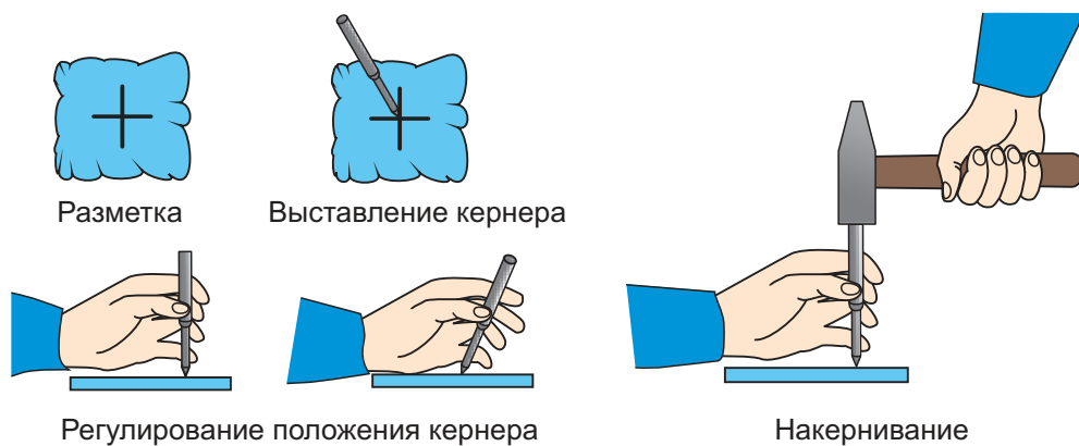
Рис. 90. Разметка кернером
