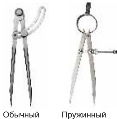
Рис. 92. Виды разметочных циркулей
