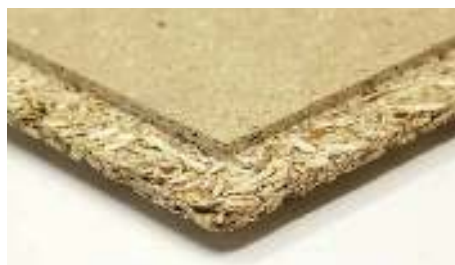
Рис. 8. Торец древесно-стружечной плиты (ДСтП)
