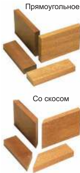
Рис. 33. Угловое соединение встык
