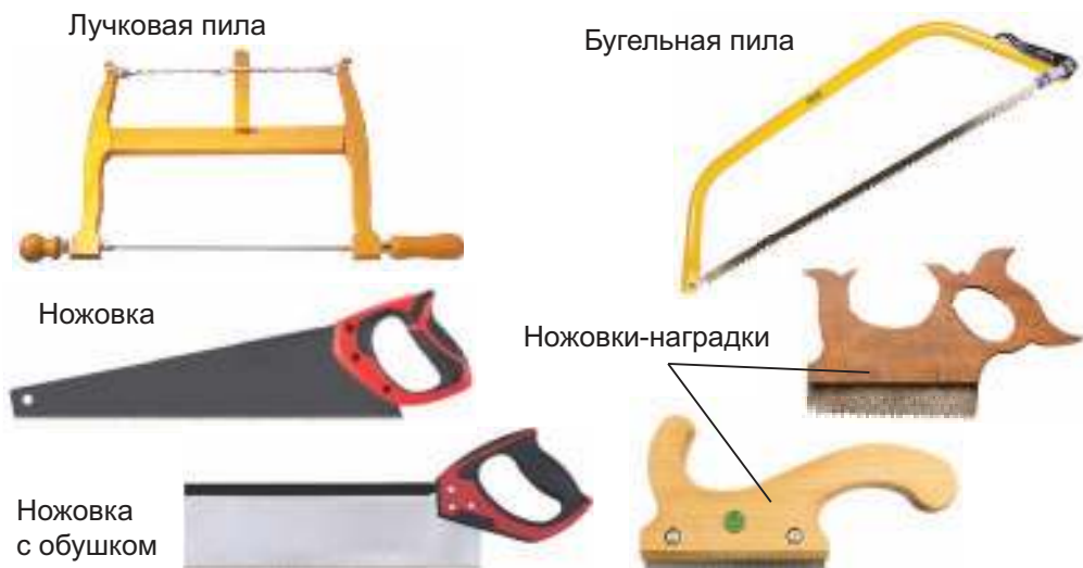
Рис. 21. Ручные инструменты для продольного пиления древесины
