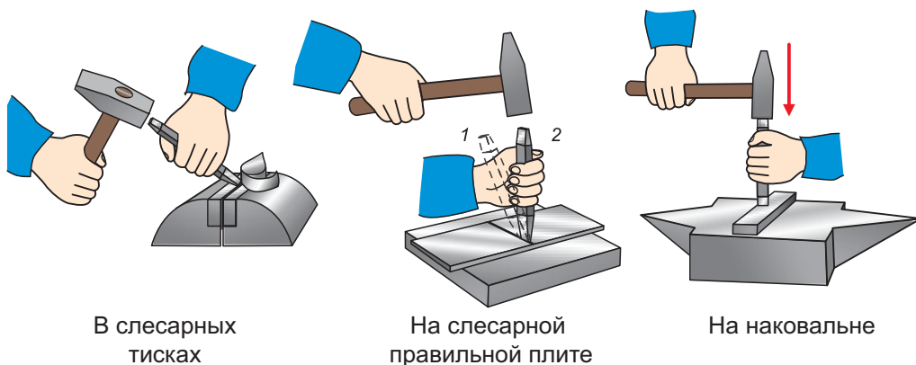
Рис. 100. Приемы рубки
