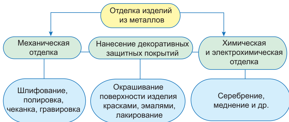
Рис. 124. Виды отделки металлов
