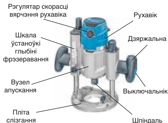
Мал. 25. Будова ручной электрычнай фрэзернай машыны (злева) і яе выкарыстанне (справа)
