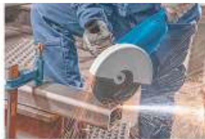
Мал. 67. Будава ручной вуглавой шліфавальнай машыны (злева) і яе выкарыстанне (справа)
