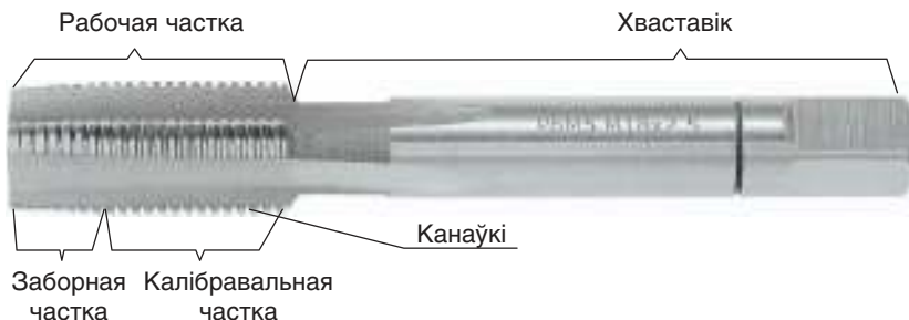
Мал. 95. Канструкцыя гайкарэза
