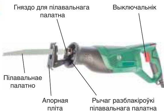
Мал. 12. Будова ручной электрычнай нажоўкі (злева) і яе выкарыстанне (справа)
