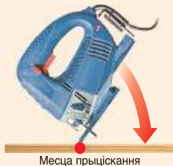
Мал. 22. Спосаб утоплівання ручнога электрычнага лобзiка
