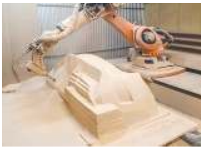
Мал. 5. Робатызаваны фрэзерны комплекс з аўтаномным кіраваннем
