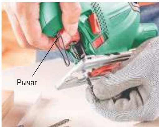
Мал. 19. Устаноўка пілавальнага палатна пры дапамозе хутказаціскачак
