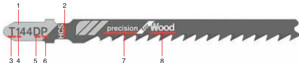
Мал. 17. Маркіроўка пілавальнага палатна ручнога электрычнага лобзіка
