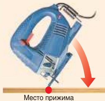
Рис. 22. Способ утапливания ручного электрического лобзика
