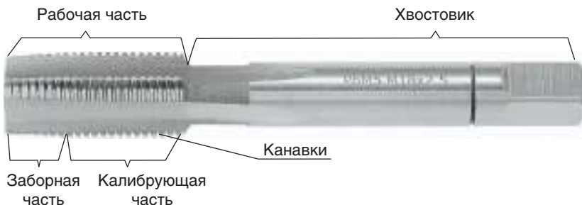
Рис. 95. Конструкция метчика
