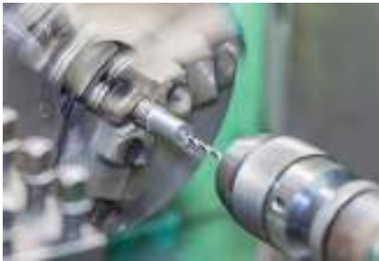
Рис. 81. Сверление на токарно-винторезном станке
