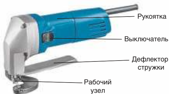
Рис. 63. Устройство ручных электрических ножниц (слева) и их использование (справа)
