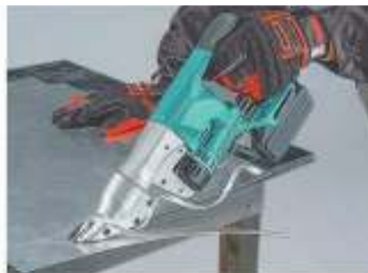
Рис. 63. Устройство ручных электрических ножниц (слева) и их использование (справа)
