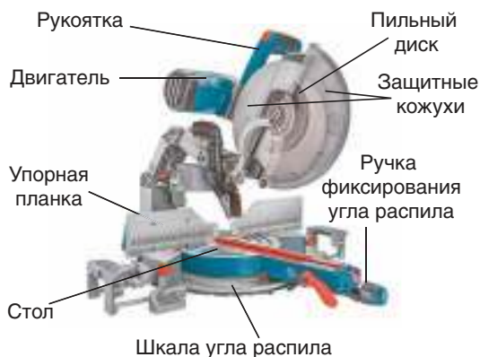
Рис. 11. Устройство торцовочной электрической дисковой пилы (слева) и ее использование (справа)
