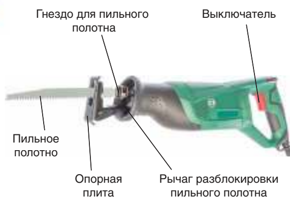
Рис. 12. Устройство ручной электрической ножовки (слева) и ее использование (справа)
