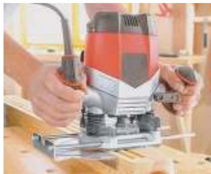
Рис. 25. Устройство ручной электрической фрезерной машины (слева) и ее использование (справа)
