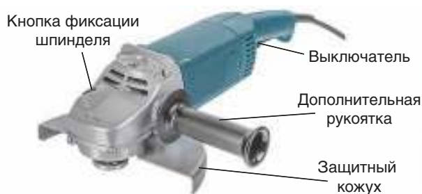
Рис. 67. Устройство ручной угловой шлифовальной машины (слева) и ее использование (справа)
