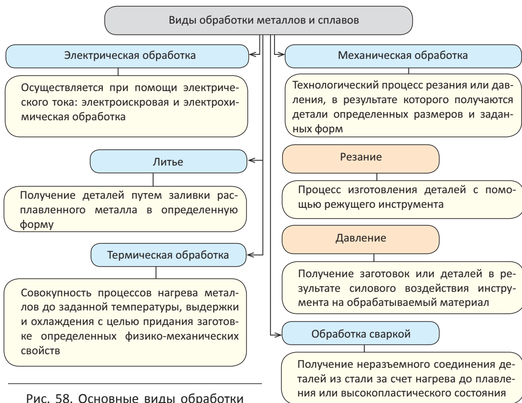
Рис. 58. Основные виды обработки металлов и сплавов
