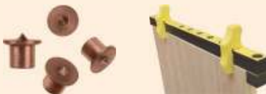
Рис. 39. Центрики (слева), кондуктор (справа)
