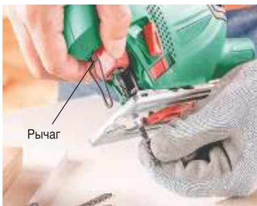
Рис. 19. Установка пильного полотна при помощи быстрозажима
