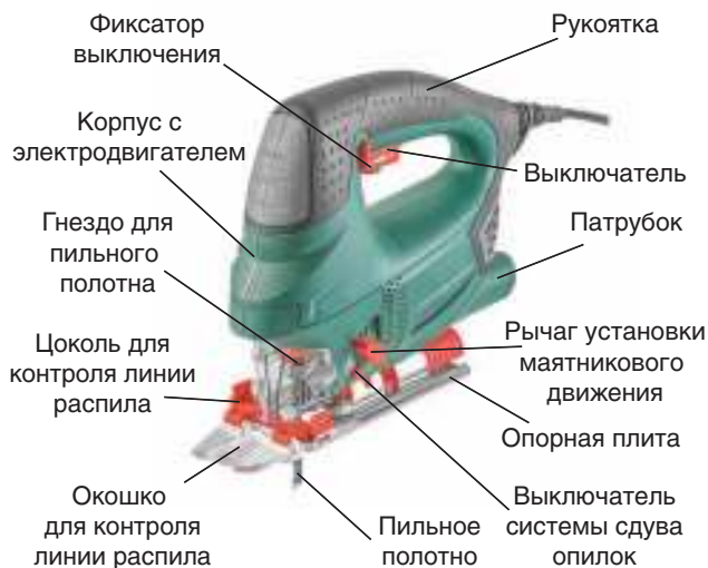
Рис. 15. Устройство ручного электрического лобзика (слева) и его использование (справа)
