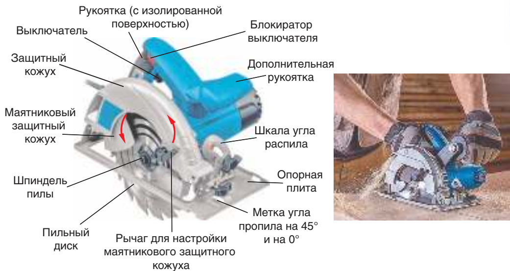
Рис. 7. Устройство ручной электрической дисковой пилы (слева) и ее использование (справа)
