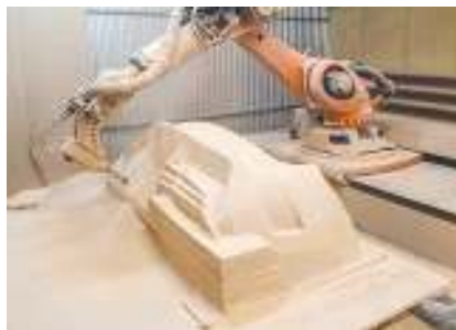
Рис. 5. Роботизированный фрезерный комплекс с автономным управлением
