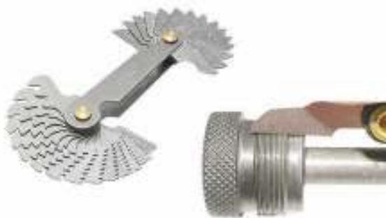
Рис. 92. Резьбомер (слева) и измерение шага резьбы (справа)
