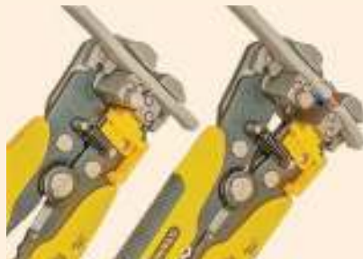
Рис. 114. Снятие изоляции стриппером
