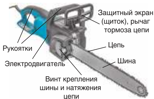
Рис. 14. Устройство ручной цепной электрической пилы (слева) и ее использование (справа)
