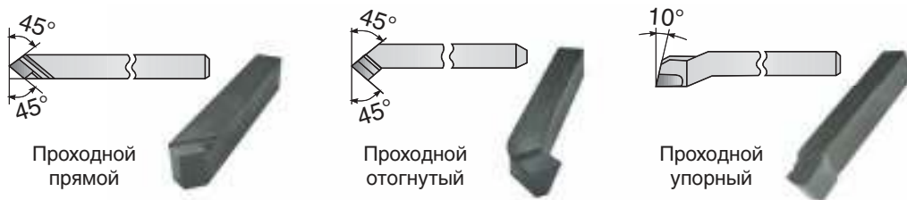
Рис. 70. Токарные резцы для точения наружных цилиндрических поверхностей
