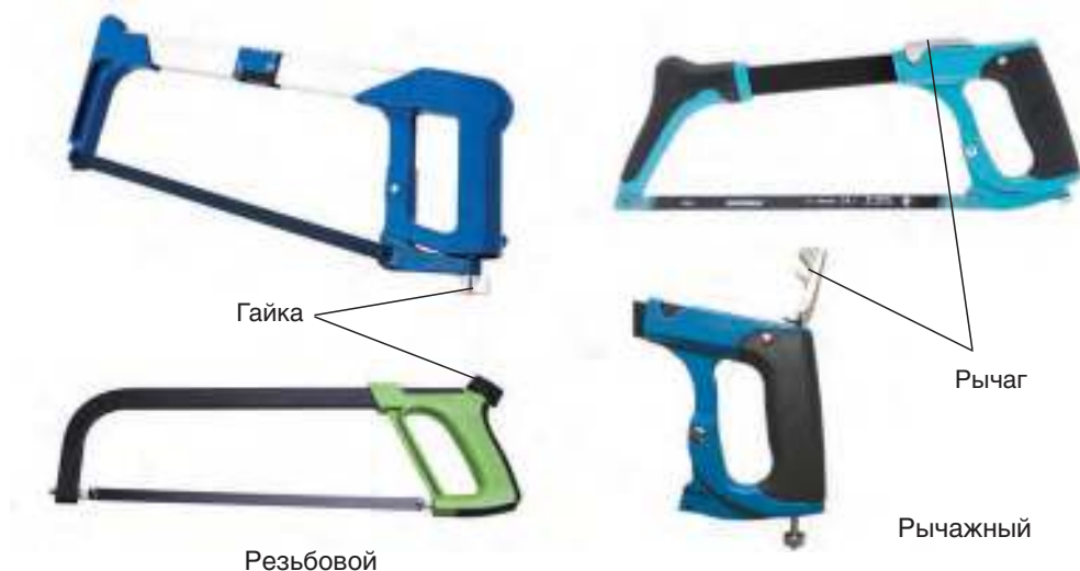
Рис. 62. Механизмы крепления ножовочного полотна
