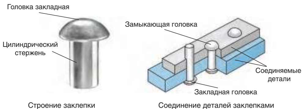
Рис. 71. Заклепочное соединение
