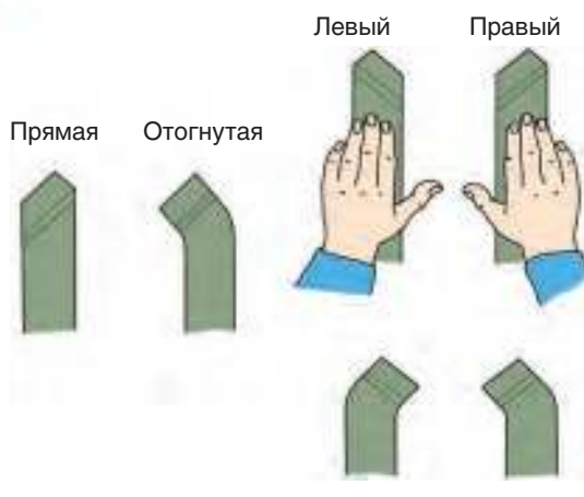
Рис. 87. Виды токарных резцов по форме головки (слева) и направлению подачи (справа)
