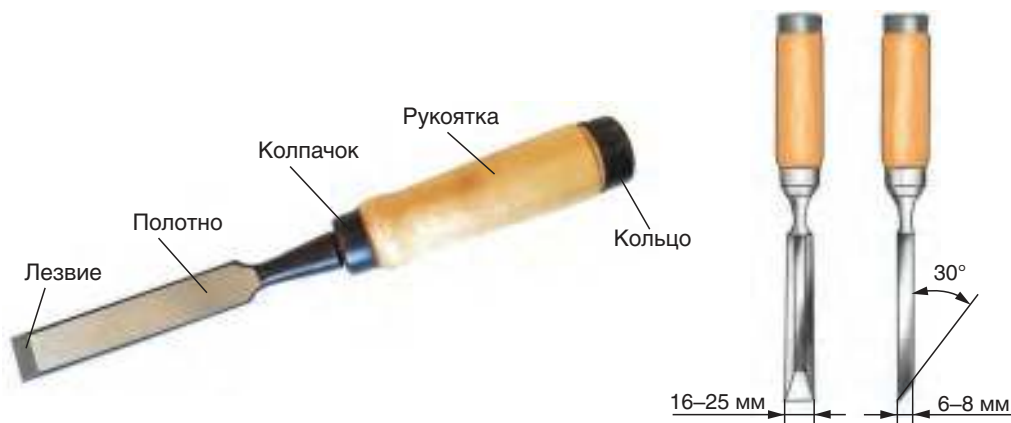
Рис. 17. Устройство долота (слева), размеры лезвия и угол заточки (справа)
