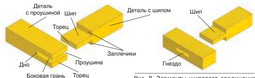
Рис. 8. Элементы шипового соединения
