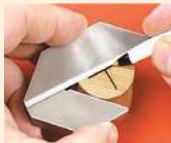
Рис. 40. Определение центра торца заготовки при помощи центроискателя
