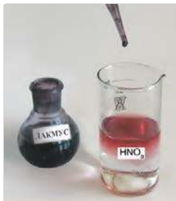
Рис. 74. Изменение окраски индикатора в растворе азотной кислоты
