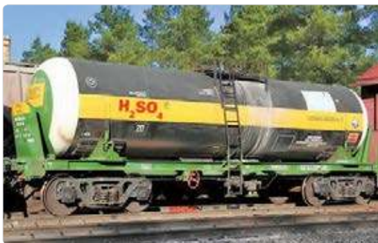
Рис. 61. Цистерна для перевозки концентрированной серной кислоты
