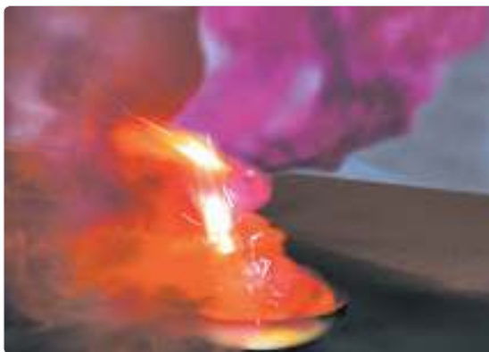
Рис. 129. Реакция алюминия с иодом
