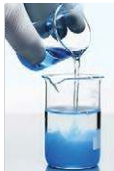
Рис. 141. Образование осадка гидроксида меди
