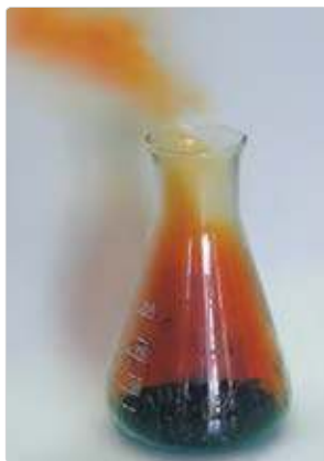
Рис. 76. Взаимодействие меди с концентрированной азотной кислотой
