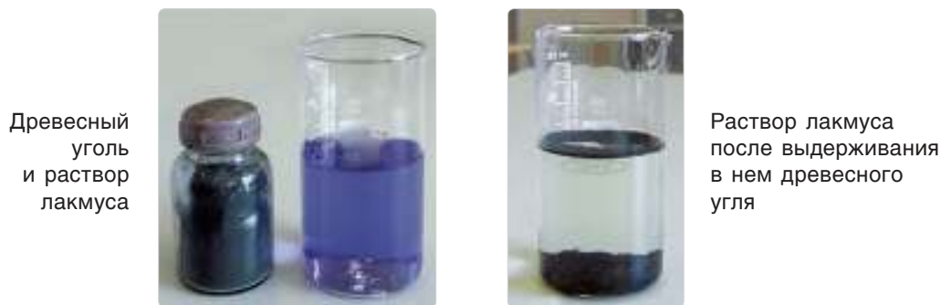
Рис. 89. Сорбционные свойства древесного угля
