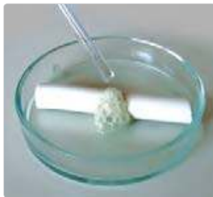
Рис. 96. Взаимодействие карбоната кальция с соляной кислотой
