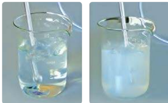
Рис. 94. Взаимодействие углекислого газа с раствором гидроксида кальция
