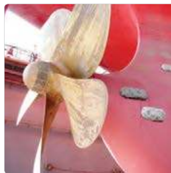
Цинковые накладки на корпусе корабля
