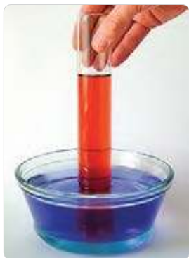
Рис. 37. Растворение хлороводорода в воде
