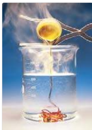
Рис. 53. Получение и строение пластической серы
