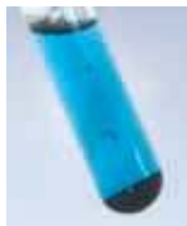
Рис. 33.1. Растворение оксида меди(II) в уксусной кислоте
