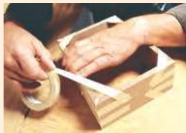
Мал. 28. Выкарыстанне малярнай стужкі для фіксацыі клеявага злучэння дэталей
