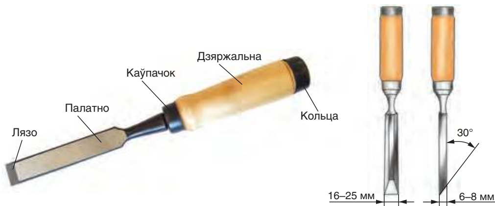
Мал. 17. Будова долата (злева), памеры ляза і вугал заточвання (справа)
