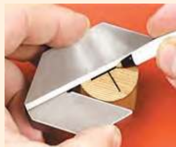
Мал. 40. Вызначэнне цэнтра тарца загатоўкі пры дапамозе цэнтрашукальніка
