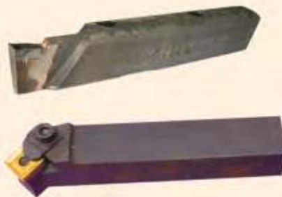
Мал. 88. Такарныя разцы: цэльны (уверсе), са зменнай пласцінай (унізе)
