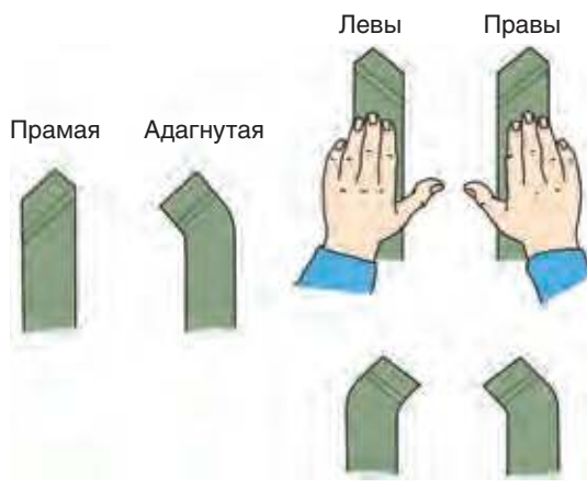
Мал. 87. Віды такарных разцоў паводле формы галоўкі (злева) і напрамку падачы (справа)
