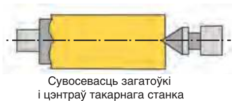
Мал. 41. Замацаванне загатоўкі ў трызубцы і заднім цэнтры
